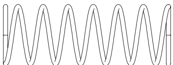
SC223-02 x2 Rear Shock Spring リヤショックスプリング
